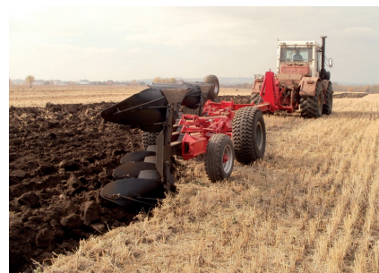
Плуг ПО-8/45К в работе с трактором К-744Р
