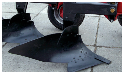
Корпуса плуга полувинтового типа с углоснимами
