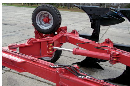
Механизм перевода поперечной балки и передних опорных колес в рабочее положение
